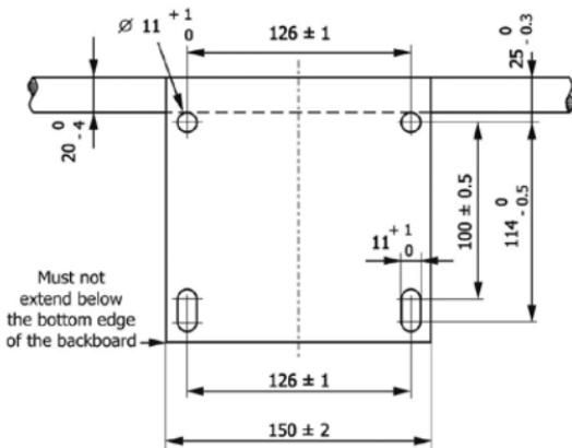
[그림 5] 링을 매다는 판 (Ring mounting plate)
